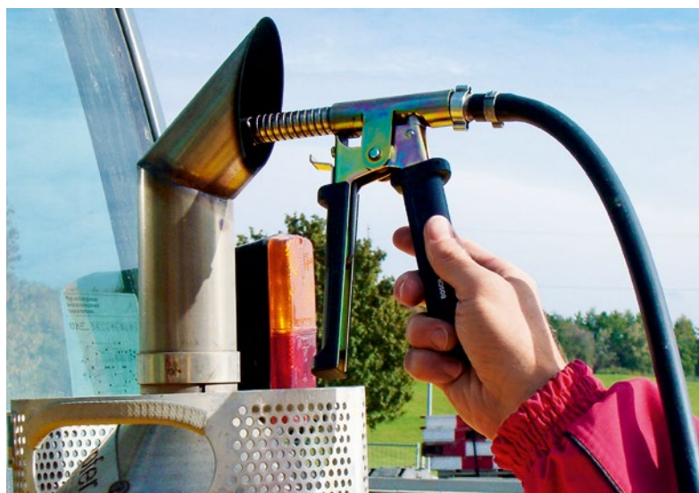
Mesure des émissions de particules pour les machines de chantier.
