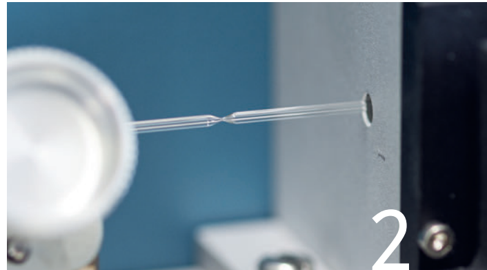
2: Das Glasröhrchen bleibt nach dem Vorverjüngen im Pipettenziehgerät eingespannt. | Après son rétrécissement, le tube en verre reste fixé dans le système d'étirement.
